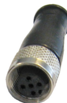
CNT-TERM: Terminazione rete CAN 120Ω. Connettore M12 5P Femmina.
